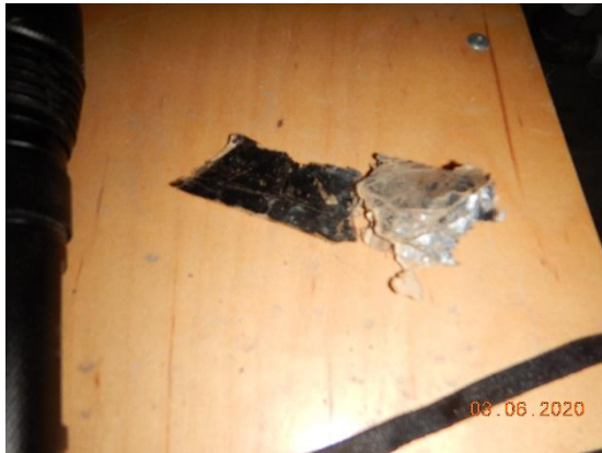
Mustasta pahvieristeestä otettu näyte ei sisältänyt asbestia.
